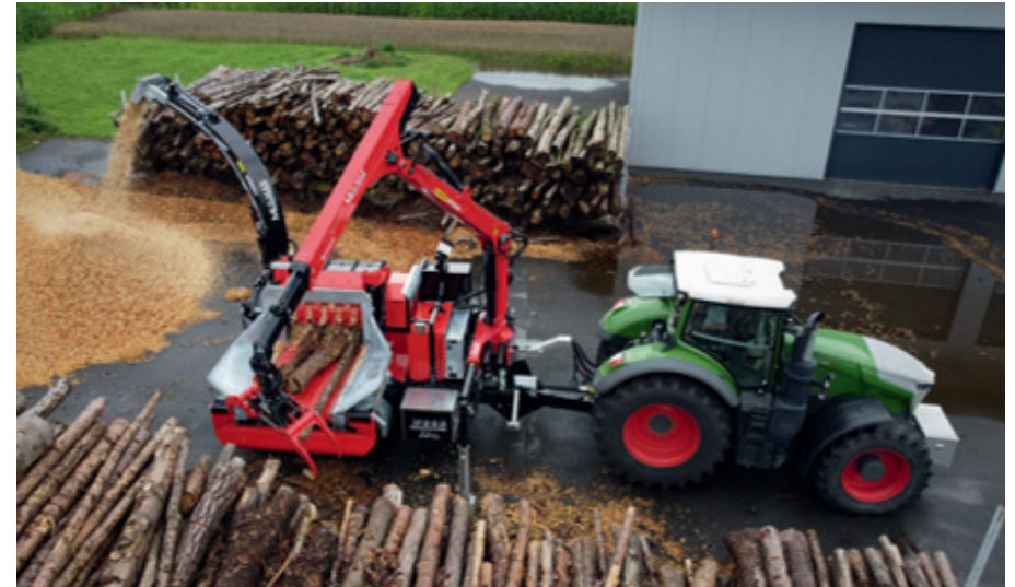
Тракторний барабанний подрібнювач із крановим завантаженням, від 100 до 600 к.с
