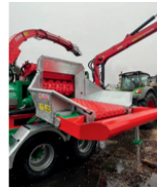
Тракторний барабанний подрібнювач із крановим завантаженням, від 100 до 600 к.с
